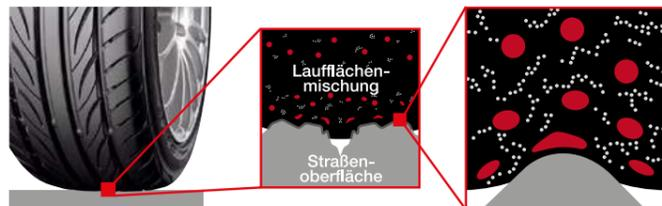
Um den sich ständig ändernden Beschaffenheiten von Oberflächen gewachsen zu sein, hat YOKOHAMA eine neue, mikroflexible Gummimischung entwickelt, die auf Verformungen der Straßenoberfläche bereits im Nano-Bereich reagiert. Durch die Addition von Micro Silica und ZERUMA wird das Fahrverhalten auf nassen Belägen nochmals verbessert; zusätzliche flexible Polymere erhöhen die Fahrleistung auf trockenen Oberflächen.
