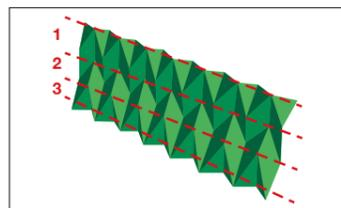
Die 3D-förmigen Lamellen geben den Profilblöcken Festigkeit auf trockenem Untergrund, optimieren den Verschleiß des Laufstreifens der Lauffläche. Der optimierte Kanteneffekt trägt zur besseren Traktion auf Schnee und nassen Oberflächen bei.
