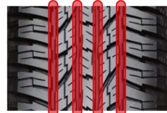
4 Hauptprofilrillen verbessern die Wasserableitung, erhöhen die Sicherheitsreserven bei Aquaplaning und verbessern das Nassbremsen.
