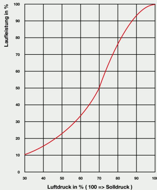
z.B.: Wird ein Reifen mit 20% Unterluftdruck gefahren, so sinkt seine Leistung durchschnittlich um 26% (Leistungsabfall von 100 auf 74%).
